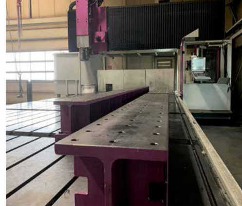
Eine der großen Mattec-Maschinen mit Verfahrwegen von 15 m, 6,2 m und 1,6 m, mit denen Sirtec das Bett und die vier Portale in Rüthen gebaut und bearbeitet hat.
