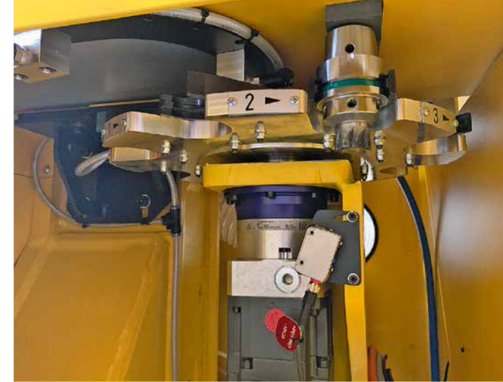
Der Werkzeugwechsler. Sirtec hat das Magazin speziell für die 24/7-Produktion von Batterierahmen mit acht Plätzen konfektioniert.
