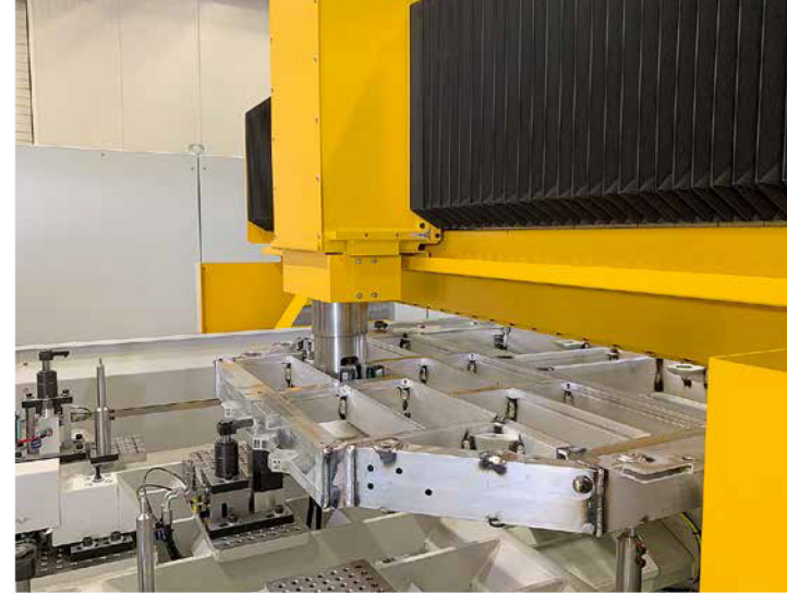
Zweiter Schritt: Sechs Laser vermessen jedes einzelnes Fach des Batterierahmens, bevor die drei Fräsportale die Schweißnähte finishen.
