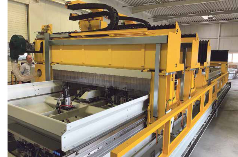
Zweite Bearbeitungsstation: Die drei Fräsportale finishen die Rückseite des Batterierahmens. Hinten rechts misst Portal 1 den nächsten Rahmen.
