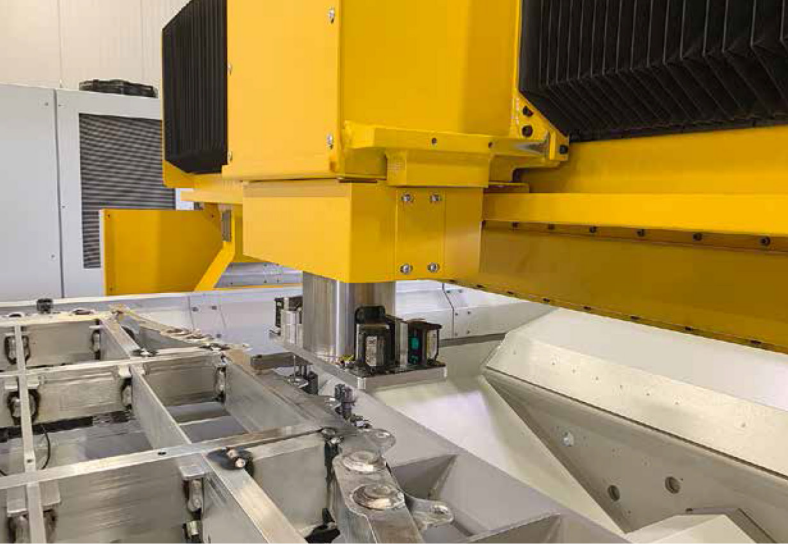
Erste Bearbeitungsstation: Im ersten Schritt werden die zwei Referenzbohrungen an jedem Batterierahmen taktil gemessen.
