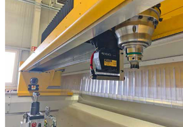
Sirtec hat zusammen mit dem Werkzeughersteller Gühring spezielle PKD-Planfräser und Bohrer entwickelt, die den Aluminium-Strangpressprofilen und den Schweißnähten lange standhalten. Die richtige Position und Zustellung wird vorher per RPS und Lasermessung ermittelt.
