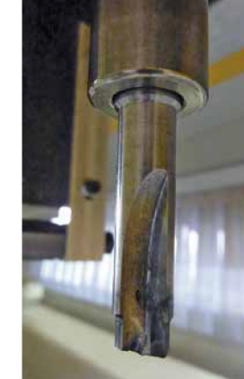
Sirtec hat zusammen mit dem Werkzeughersteller Gühring spezielle PKD-Planfräser und Bohrer entwickelt, die den Aluminium-Strangpressprofilen und den Schweißnähten lange standhalten. Die richtige Position und Zustellung wird vorher per RPS und Lasermessung ermittelt.
