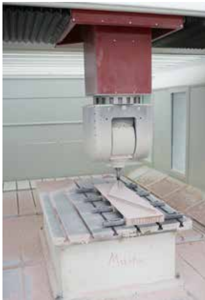
4 Ureol-Fahrzeugkomponente mit Oberflächenstruktur in Bearbeitung (© EDAG)
