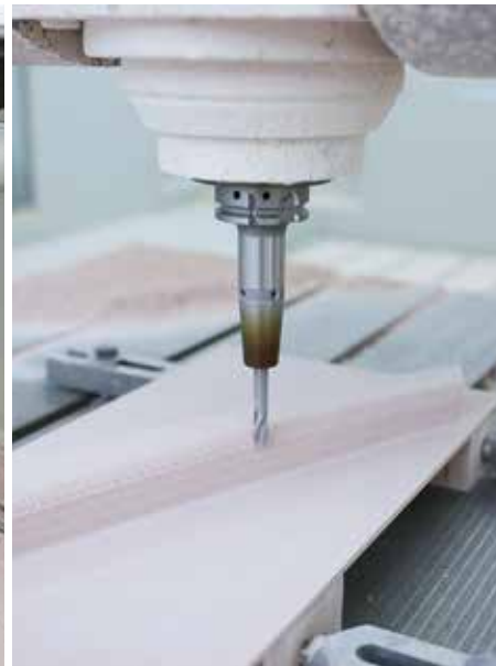
4 Ureol-Fahrzeugkomponente mit Oberflächenstruktur in Bearbeitung (© EDAG)
