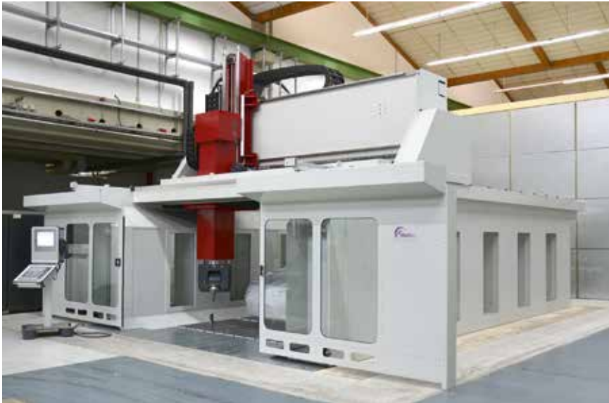
1 Die neue 5-Achs-Hochportal-Fräsmaschine Mattec 65-35-40 high bei EDAG in Fulda; von SIRtec konzipiert für das dynamische Komplettbearbeiten/Schlichten von 1:1-Fahrzeugmodellen an bis zu sechs Seiten im bedienerlosen Betrieb (© Hanser)
