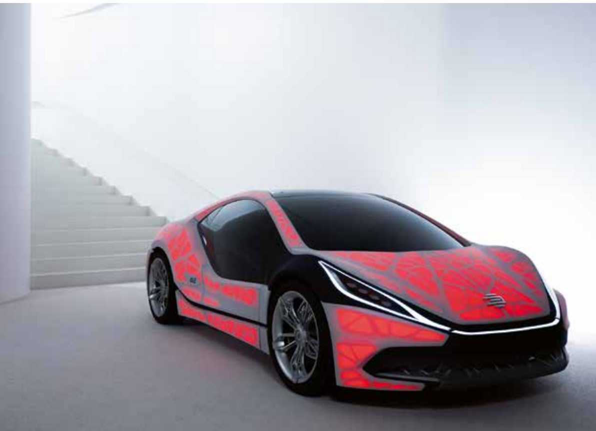
Light Cocoon aus dem Hause EDAG: Dieses Konzeptauto feierte Premiere auf dem Genfer Autosalon 2015; es besteht aus einer bionisch optimierten Fahrzeugstruktur, die mit einem Stoff des Outdoor-Ausrüsters Jack Wolfskin überspannt ist; eine LED-Beleuchtung rückt die futuristische Wabenkonstruktion ins rechte Licht (© EDAG)
