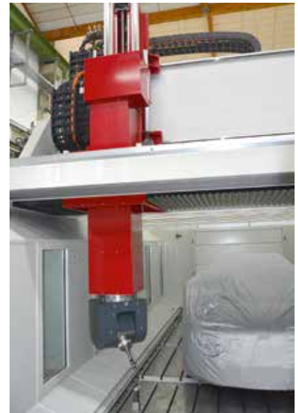
3 Konzeptionelle Alleinstellung in der Z-Achse: Statt eines Stößels (RAM) verbaut SIRtec beim neuen Hochportal einen Schieber; höhere Steifigkeit und bessere Oberflächen beim Schlichten sind die positiven Effekte für den Kunden EDAG (© Hanser)
