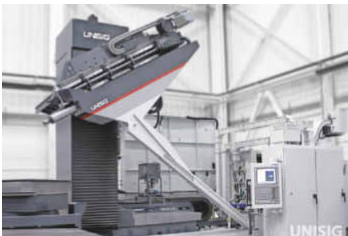
USC-M-Serie: Für die Maschinen gibt's ein automatisches Werkzeugwechsel-System für bis zu 120 Tools. Bild: Unisig
